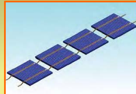
Ηλεκτρική σύνδεση ηλιακών στοιχείων
