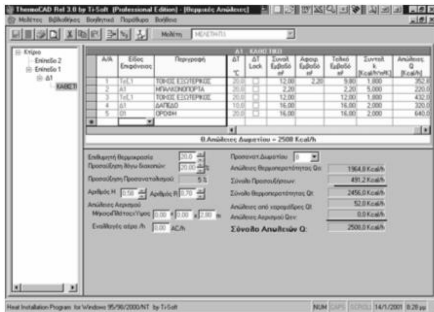
Εικόνα 7. Συνέχεια του λογιστικού φύλλου υπολογισμού θερμικών απολειών του προγράμματος με τα υπόλοιπα πεδία συμπληρωμένα
