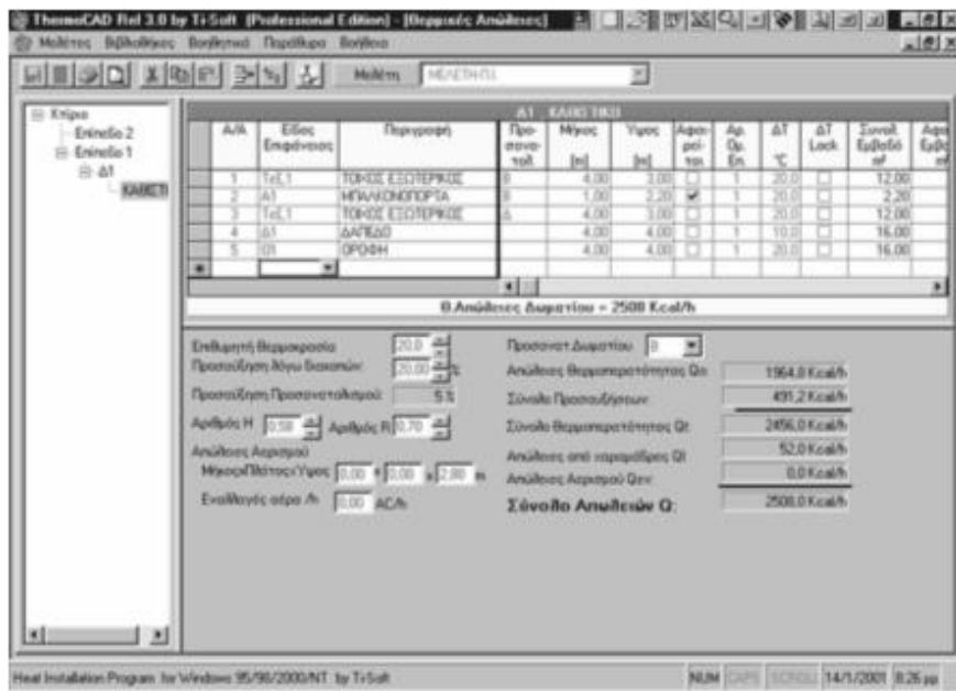
Εικόνα 6. Το λογιστικό φύλλο υπολογισμού θερμικών απολειών του προγράμματος (χωρίς μόνωση των δομικών στοιχείων), με επί πλέον προσαυξήσεις α) λόγω διακοπών λειτουργίας, β) από χαραμάδες και την δυνατότητα ανανεώσεων του αέρα
