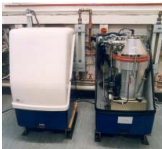
Μικρό σύστημα συμπαραγωγής για οικιακή χρήση με μηχανή Stirling
