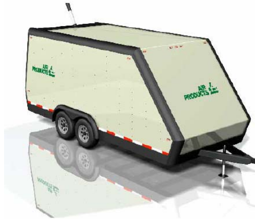
Κινητή μονάδα ανεφοδιασμού με υδρογόνο
