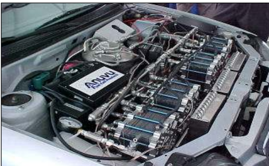
Σχήμα 5.15: Μηχανή αυτοκινήτου τροφοδοτούμενη από στήλη κυψελών PEMFC σε σειρά [58].
