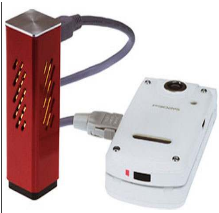
Σχήμα 7.5: Κινητό τηλέφωνο μικροκυψέλης καυσίμου υδρογόνου μαζί με συσκευή «αναμόρφωσης» νερού σε υδρογόνο που αναπτύχθηκε από το Ερευνητικό κέντρο Fuel Cell Development Information Center (FCDIC) στην Ιαπωνία [91] .
