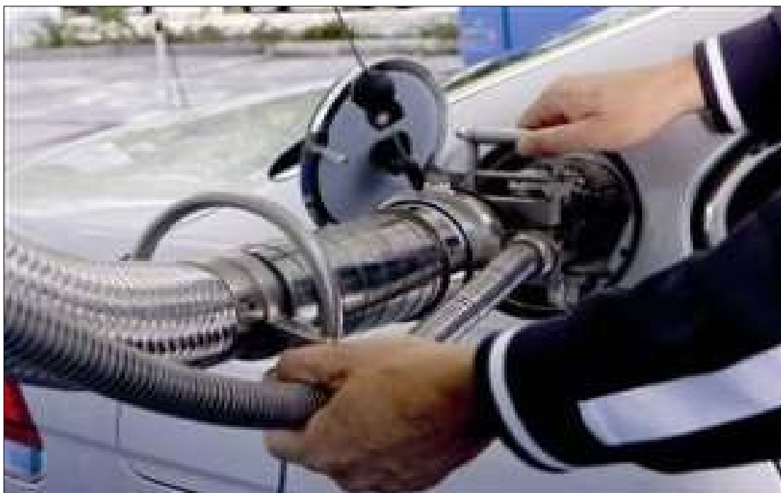
Σχήμα 6.3: Σωλήνας πλήρωσης για ανεφοδιασμό με υγρό υδρογόνο του Sedan 760Li [83].
