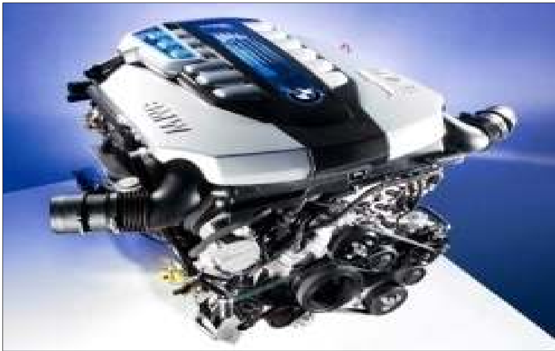
Σχήμα 6.2: Ο δωδεκακύλινδρος κινητήρας καύσης τύπου "dual-mode" του εμπορικού μοντέλου Sedan 760Li της BMW. Έχει τα εξής χαρακτηριστικά: μέγιστη ισχύ τα 191 kW, 260 hp και μέγιστη ροπή τα 390 Nm στις 4300 rpm, ανεξάρτητα από το είδος του καυσίμου που χρησιμοποιεί (υδρογόνο ή βενζίνη) [83].
