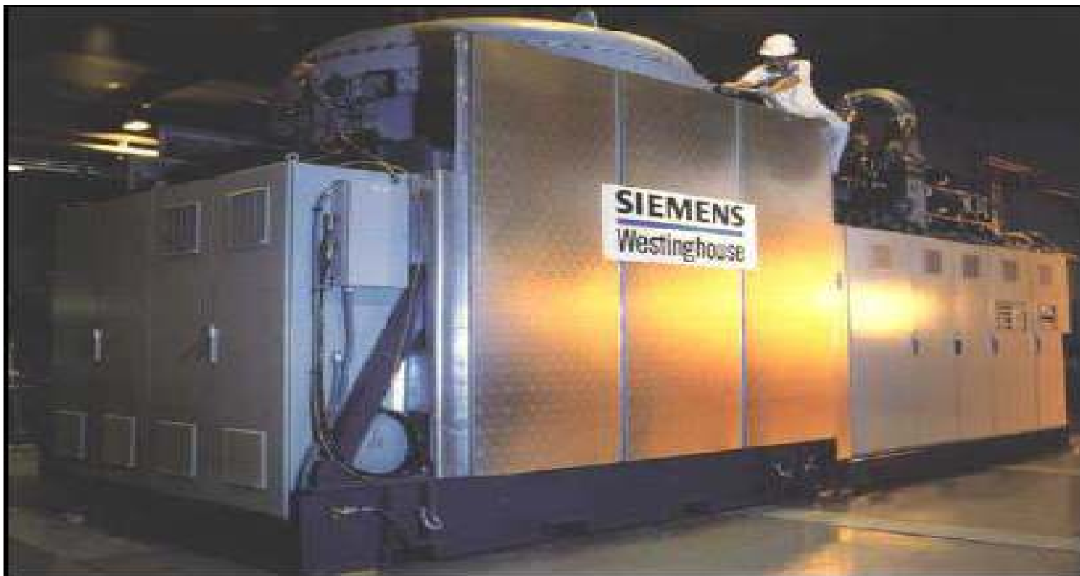
Σχήμα 7.3: Υβριδική μονάδα παραγωγής ηλεκτρικής ενέργειας της Siemens-Westinghouse ισχύος 220 KW, που συνδυάζει κυψέλες καυσίμου τύπου SOFC με αεριοστρόβιλο. Είναι η πρώτη του είδους της στον κόσμο [89].
