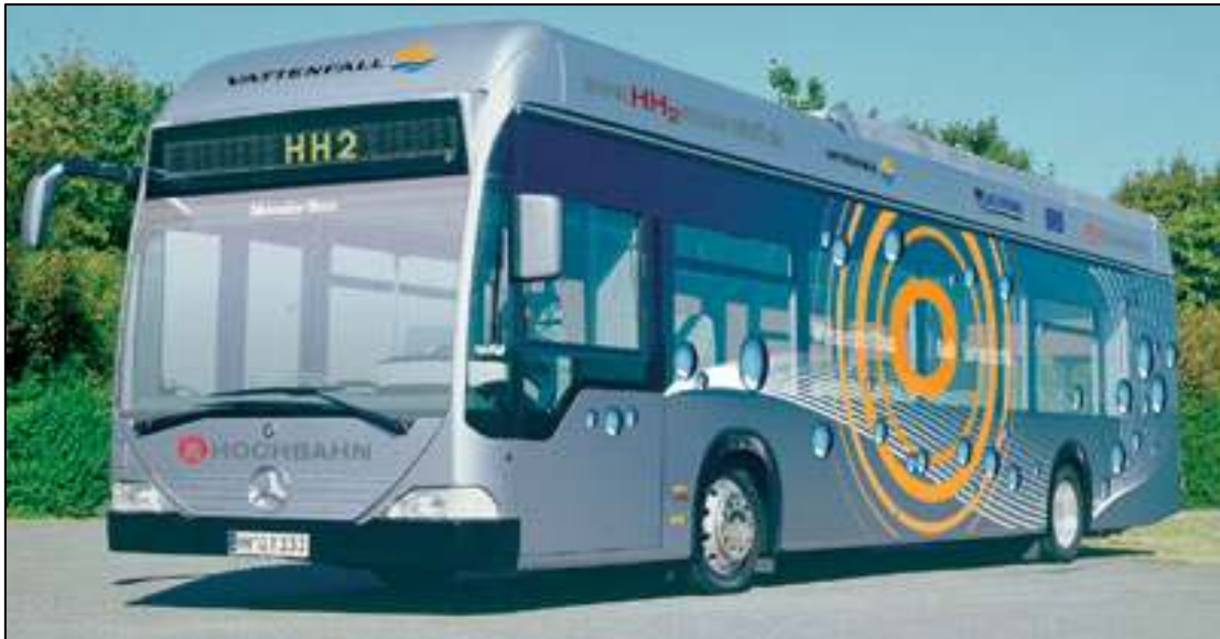
Σχήμα 2.6: Αστικό επιβατικό λεωφορείο με κυψέλες καυσίμου υδρογόνου (τέθηκε για πρώτη φορά σε κυκλοφορία το 2006 στην πόλη του Αμβούργου στη Γερμανία).
