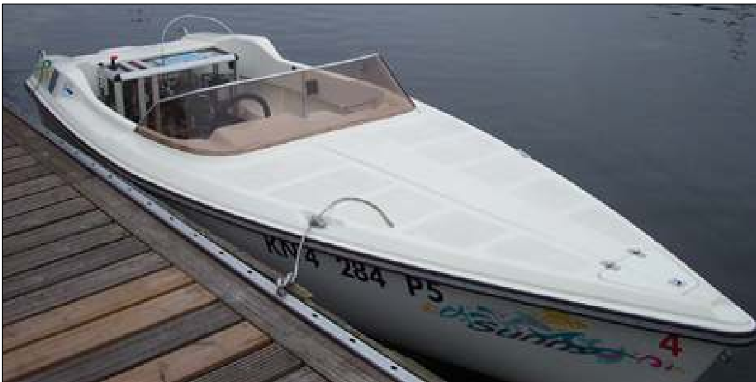
Σχήμα 7.4: Υδρογονοκίνητο ταχύπλοο κινούμενο με κυψέλες καυσίμου τύπου PEMFC συνολικής ισχύος 800W που κατασκευάστηκε από την εταιρία Zebotec GmbH και άλλους συμπαραγωγούς στη Γερμανία. Το υδρογόνο που χρησιμοποιεί αποθηκεύεται σε στερεά μεταλλικά υδρίδια ενώ το ίδιο αναπτύσσει μέγιστη ταχύτητα 8 κόμβων [90].
