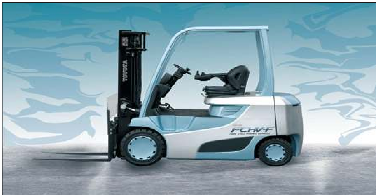
Σχήμα 7.2: Πρωτότυπο μεταφορικού οχήματος εργασίας της Toyota κινούμενο μέσω κυψελών (PEMFC) [85].
