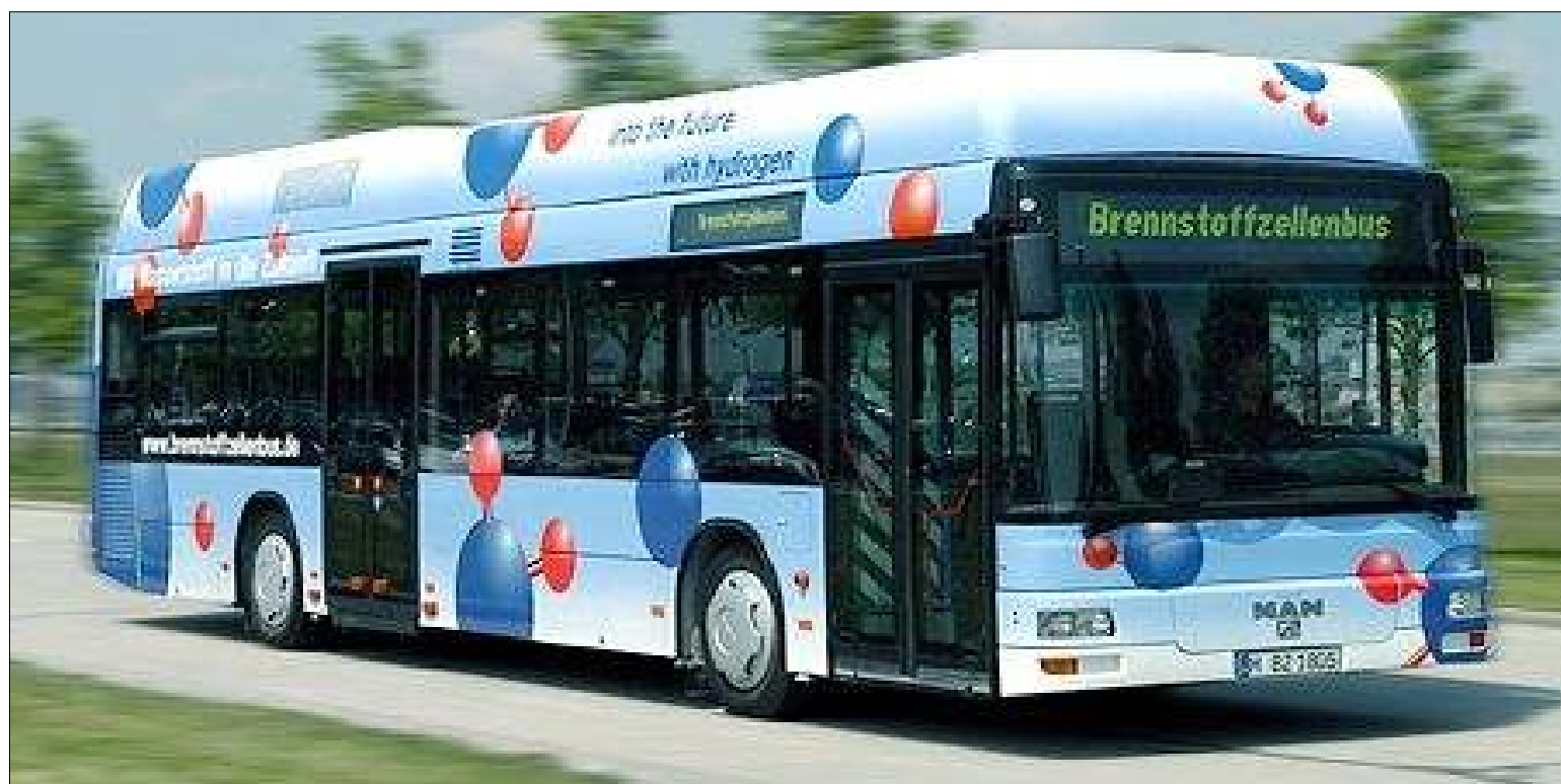
Σχήμα 7.3: Αστικό επιβατικό λεωφορείο επίδειξης μήκους 12m κινούμενο με κυψέλες υδρογόνου (PEMFC) και ηλεκτρικές μπαταρίες τύπου NiMH, που κατασκευάστηκε από την εταιρία MAN στα πλαίσια του προγράμματος ARGEMUC και τέθηκε σε λειτουργία τον Μάιο του 2004 στο αεροδρόμιο του Μονάχου της Γερμανίας [86].
