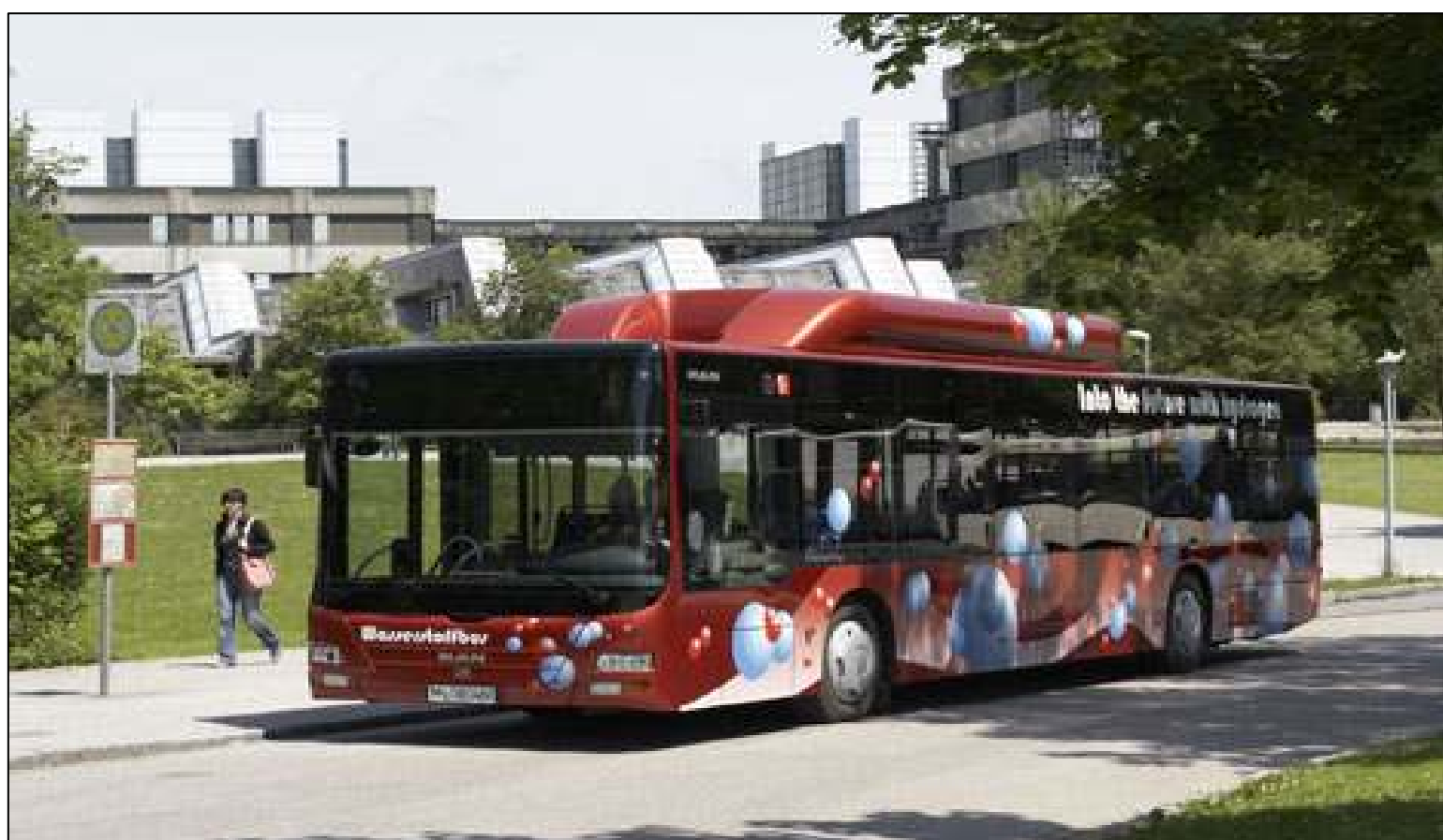
Σχήμα 7.4: Αστικό επιβατικό λεωφορείο της εταιρίας MAN κινούμενο με ΜΕΚ υδρογόνου που τέθηκε σε κυκλοφορία το 2006/2007 στο Μόναχο της Γερμανίας, ως μέρος του ευρωπαϊκού προγράμματος HyFLEET:CUTE [87].
