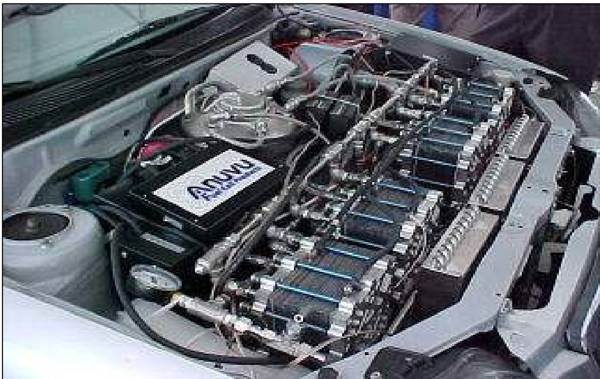
Σχήμα 5.3: Μηχανή αυτοκίνητου τροφοδοτούμενη από συστοιχία κυψελών καυσίμου PEMFC σε σειρά [58].
