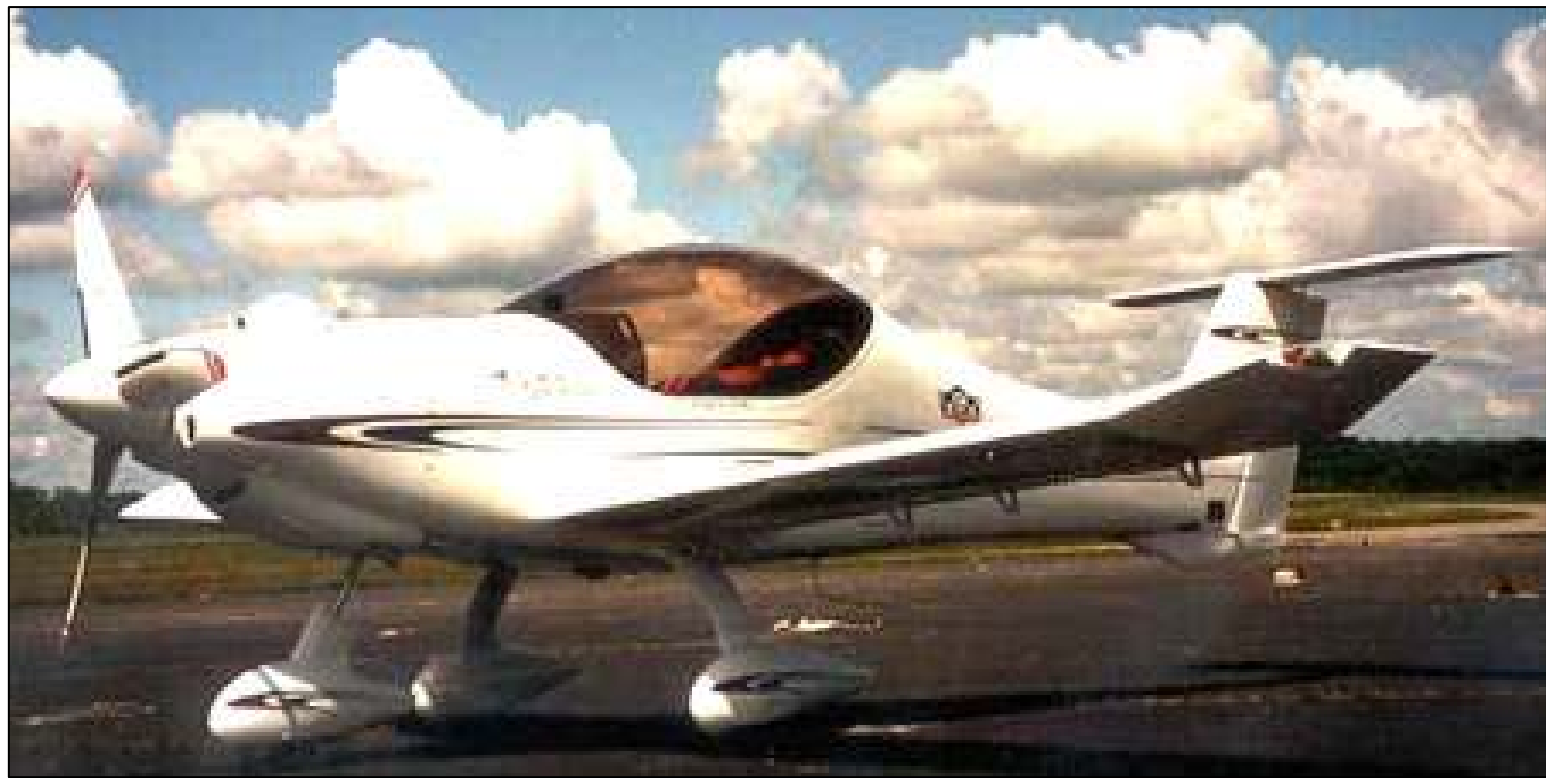
Σχήμα 7.6: Μονοθέσιο επιβατικό αεροπλάνο που αναπτύχθηκε από τη NASA και διάφορες άλλες συμμετέχοντες εταιρίες, κινούμενο μέσω ενέργειας υδρογόνου [93].
