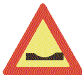
(Κ - 11) Επικίνδυνο κάθετο ρεί- θρο (αυλάκι) ή απότομη κοίλη αλλαγή της κατά μήκος κλίσης της οδού.
