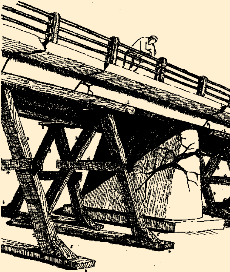
Σχ. 5. Πολλαπλή τριγωνική υποστήλωση με ξύλινες δοκούς εκατέρωθεν βλαμμένου βάθρου γέφυρας
