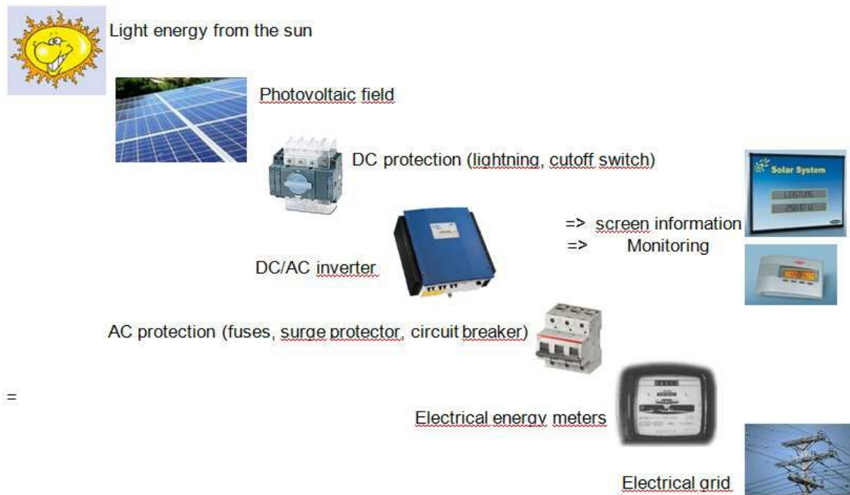
Εικ. 1 - Απλοποιημένο διάγραμμα μιας φωτοβολταϊκής εγκατάστασης
