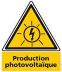
Εικόνα 24 : Περιγραφική ετικέτα που δείχνει τη σύνδεση της φωτοβολταϊκής εγκατάστασης.
