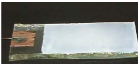
Σχήμα 4.6: Ηλεκτρόδιο \text{TiO}_2 με εμπορική Degussa P25 σε FTO [16]
