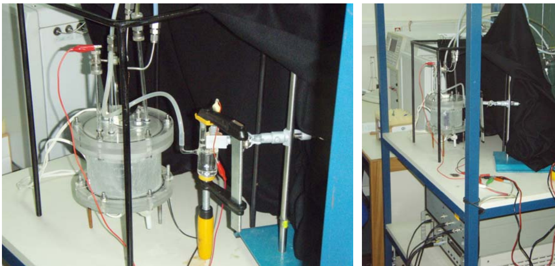
Σχήμα 4. 15 Φωτογραφία του φωτοηλεκτροχημικού αντιδραστήρα συνδεδεμένου (αριστερά) και γενικό πλάνο της πειραματικής διάταξης (δεξιά).
