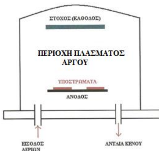
Σχήμα 2.4.1: Απλοποιημένο σύστημα ιοντοβολής [19]
