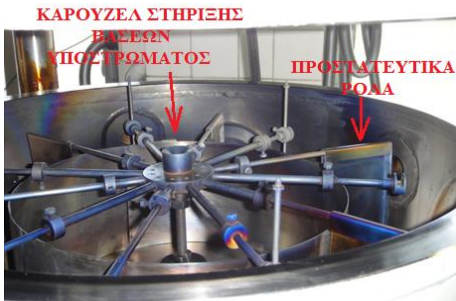
Σχήμα 3.1.4: Το εσωτερικό του θαλάμου εναπόθεσης και η βάση στήριξης των υποστρωμάτων
