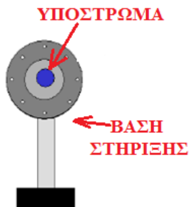
Σχήμα 3.2.3: Σχηματική διάταξη της βάσης στήριξης και θέρμανσης του υποστρώματος
