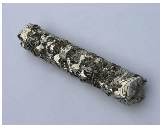
Εικόνα 3.2 Κρυσταλλική ράβδος τιτανίου, η οποία παρήχθη με τη μέθοδο Kroll ( http://el.wikipedia.org/wiki/Titan-crystal_bar.JPG )
