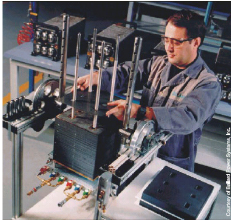
Σχήμα 5 : Συναρμολόγηση στήλης κυψέλης καυσίμου.
