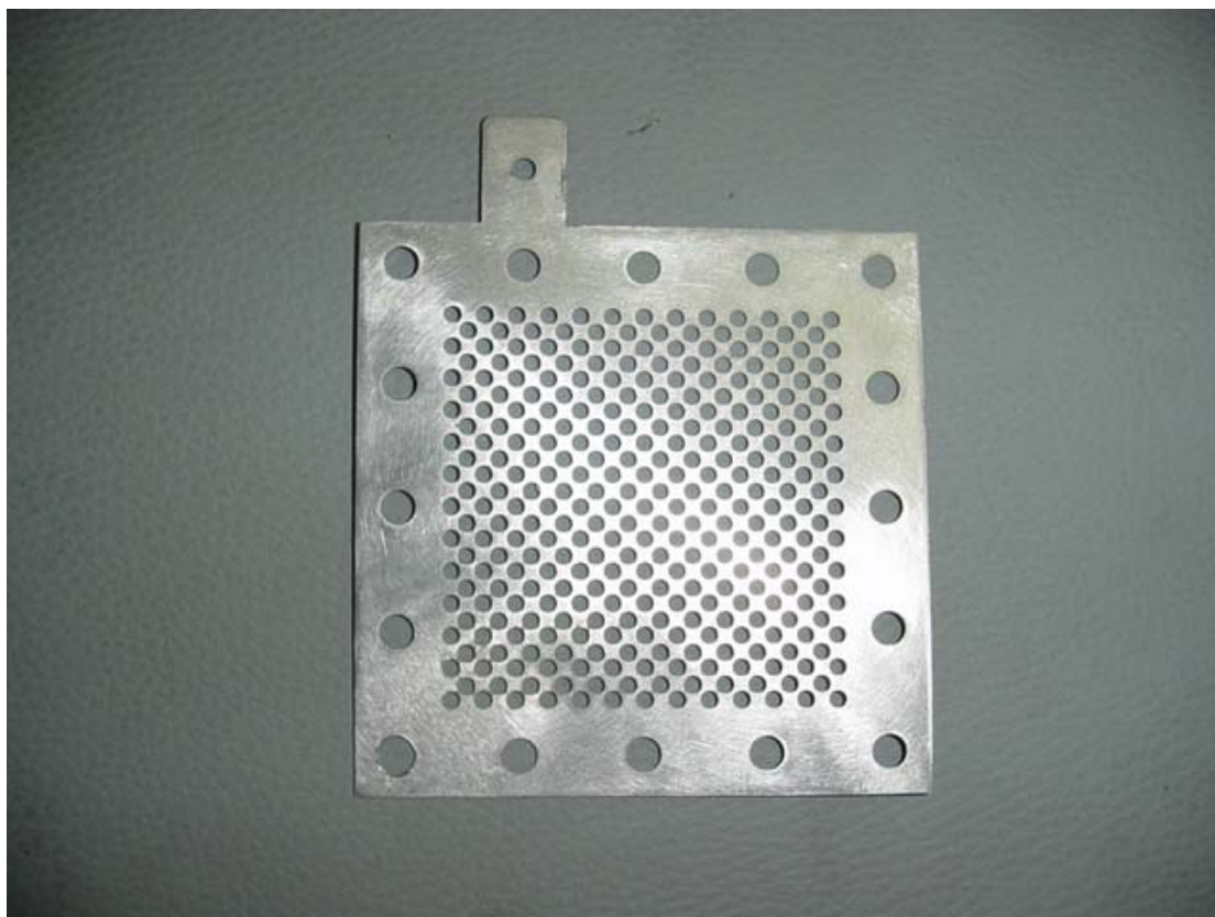
Εικόνα 25: Ηλεκτρόδιο πειραματικής κυψέλης (πηγή: Tropical)
