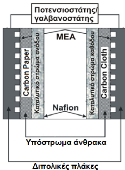
Σχήμα 3.4: Σχηματική αναπαράσταση της γεωμετρίας της κυψέλης καυσίμου που χρησιμοποιήθηκε για την ηλεκτρόλυση του νερού.
