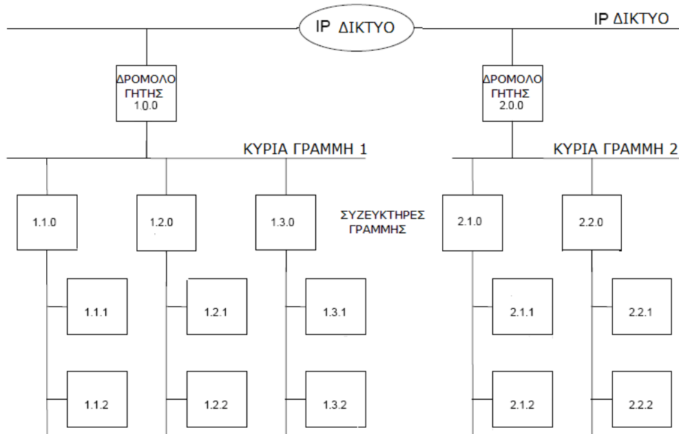
Εικόνα 46: Σύνδεση περιοχῶν και χρήση δρομολογητῶν ως συζευκτῆρες περιοχῶν
