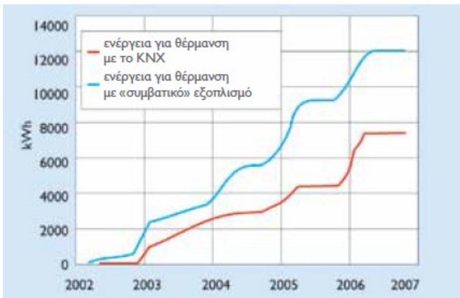
Σχήμα 3 Σύγκριση συμβατικής και KNX λειτουργίας συστήματος θέρμανσης από το Πανεπιστήμιο της Βρέμης [3].
