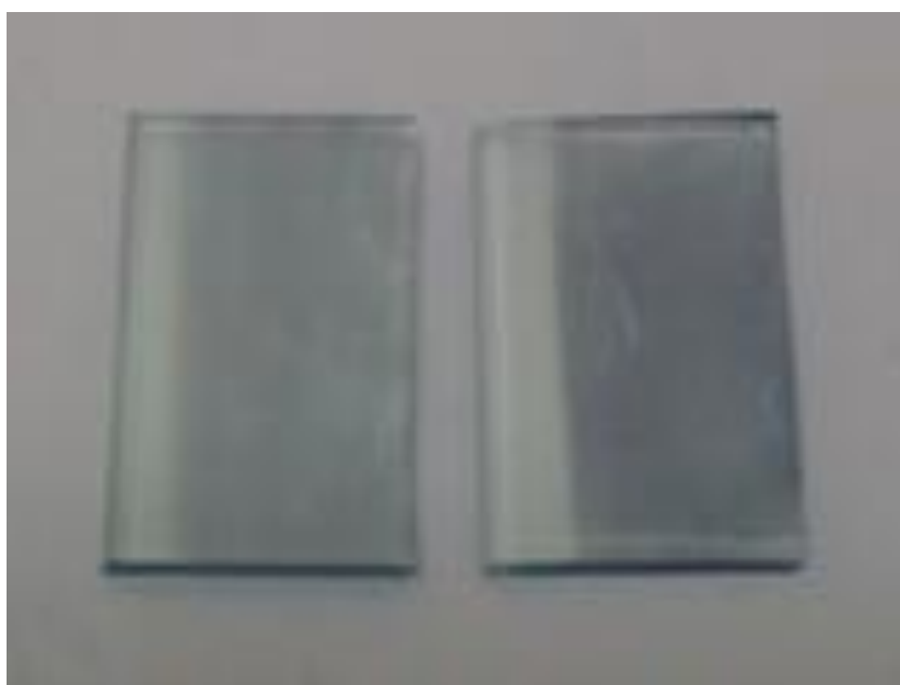
Σχήμα 2.5: Αντιηλεκτρόδια με επίστρωση Pt.
