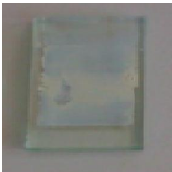
Σχήμα 2.1: Ηλεκτρόδιο ανόδου με υμένιο \text{TiO}_2 .
