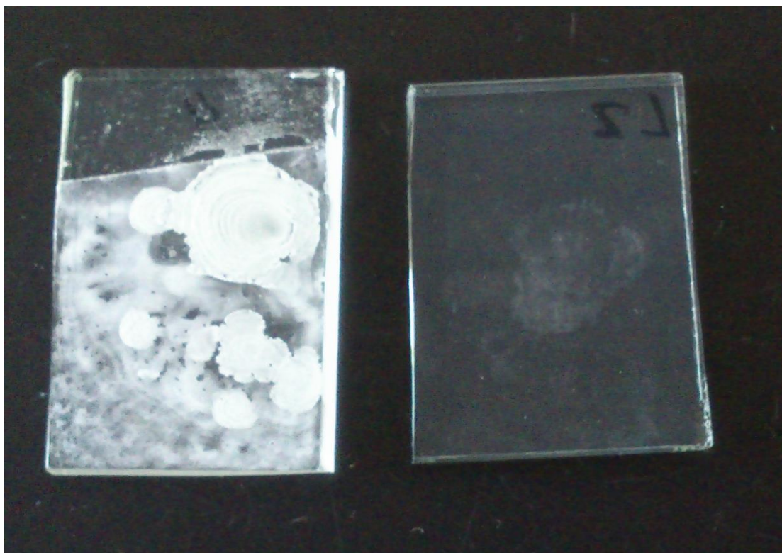
Σχήμα 3.13: Εικόνα του ηλεκτροδίου της ανόδου με υμένιο WO_3 , πριν και μετά τη φωτοκαταλυτική διεργασία.
