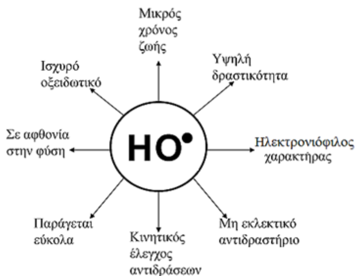
Σχήμα 2.2: Ορισμένες χαρακτηριστικές ιδιότητες των ριζών \text{HO}^\bullet (Oppenländer, 2003).
