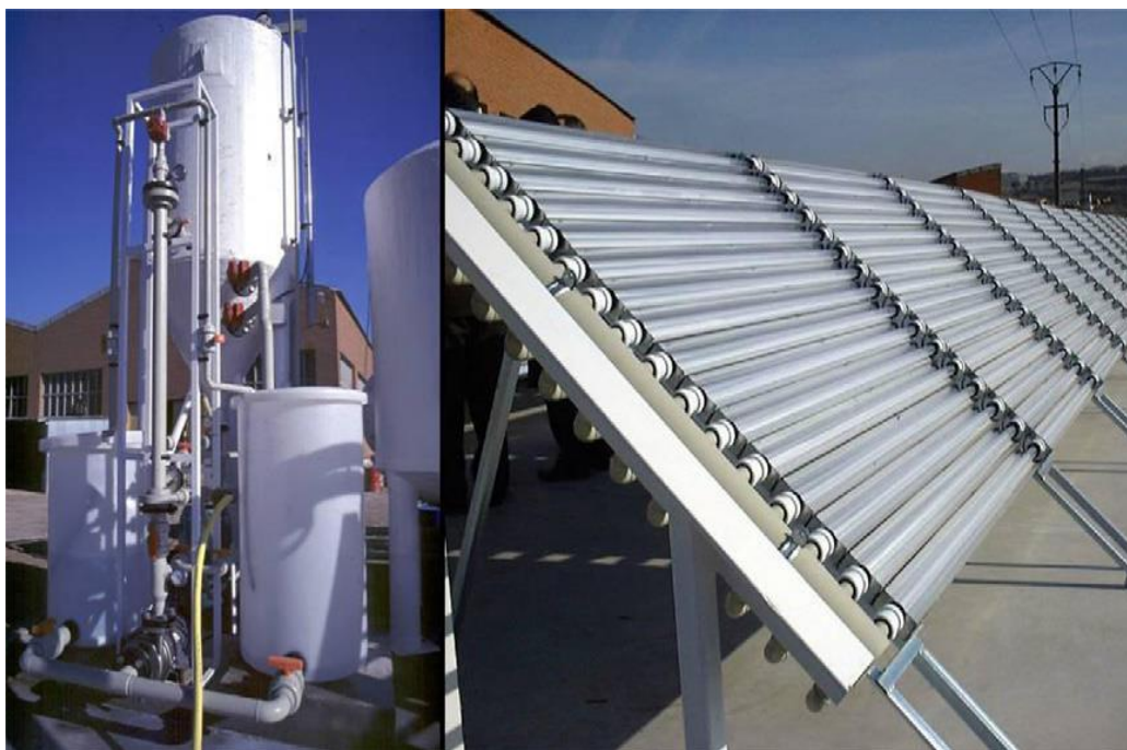
Σχήμα 3.26: Φωτοκαταλυτική μονάδα επεξεργασίας τοξικών αποβλήτων (Μαδρίτη, Ισπανία). Αριστερά: Σύστημα Διαχωρισμού \text{TiO}_2 , Δεξιά: Σύνθετος παραβολικός ηλιακός φωτοαντιδραστήρας (Malato et al., 2009).
