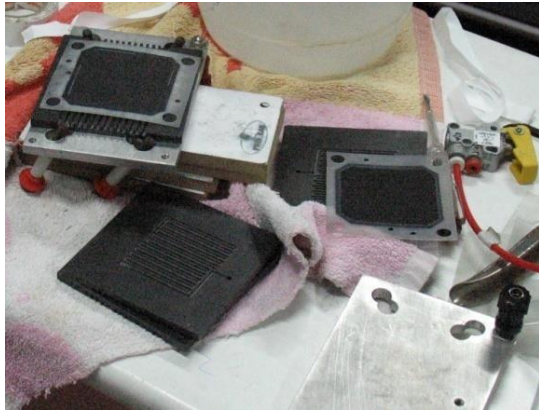
Εικόνα 8. Συναρμολόγηση κυψέλης καυσίμου
