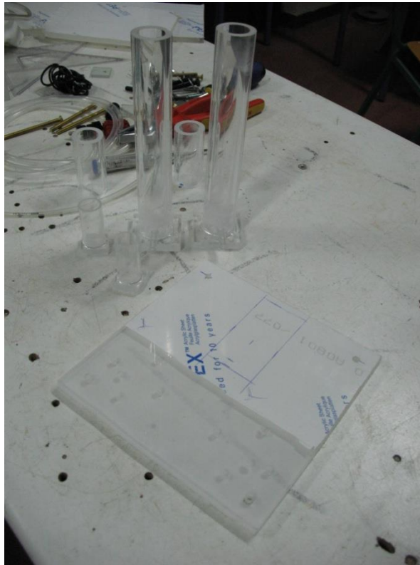
Εικόνα 5. Κατασκευή Δοχείων Αποθήκευσης των Παραγόμενων Αερίων & Βάση Στήριξης
