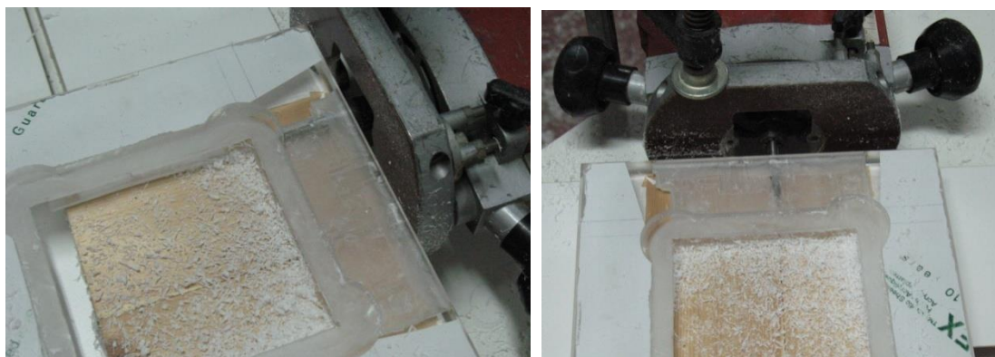
Εικόνα 3. Λειτουργία Router κοπή για το άνοιγμα υποδοχή
