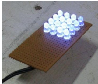
Εικόνα 3. Λειτουργία φωτεινής Πηγής Leds UV 16 τεμαχίων
