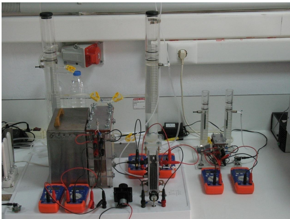
Εικόνα 6. Λειτουργία Μονάδας Ηλεκτρόλυσης και Κυψέλης Καυσίμου (Τελική Μορφή)
