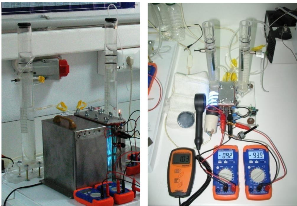
Εικόνα 75 Μεγάλη I και με την Μικρή II Φωτοηλεκτροχημική Κυψελίδα σε λειτουργία Φωτοηλεκτροκατάλυσης
