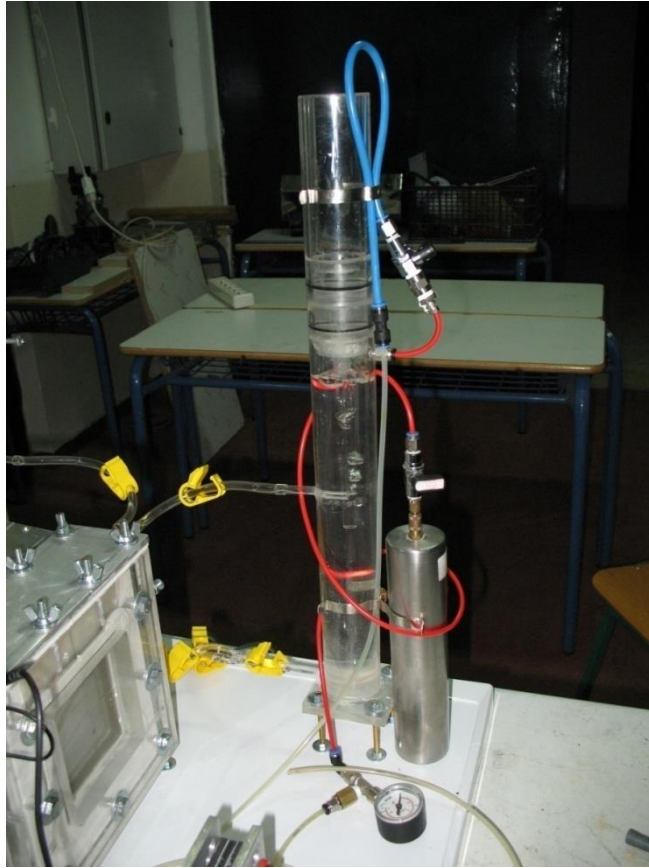
Εικόνα 3. Η Πρώτη Παραγωγή Υδρογόνου από τη Μονάδα Ηλεκτρόλυσης (I)
