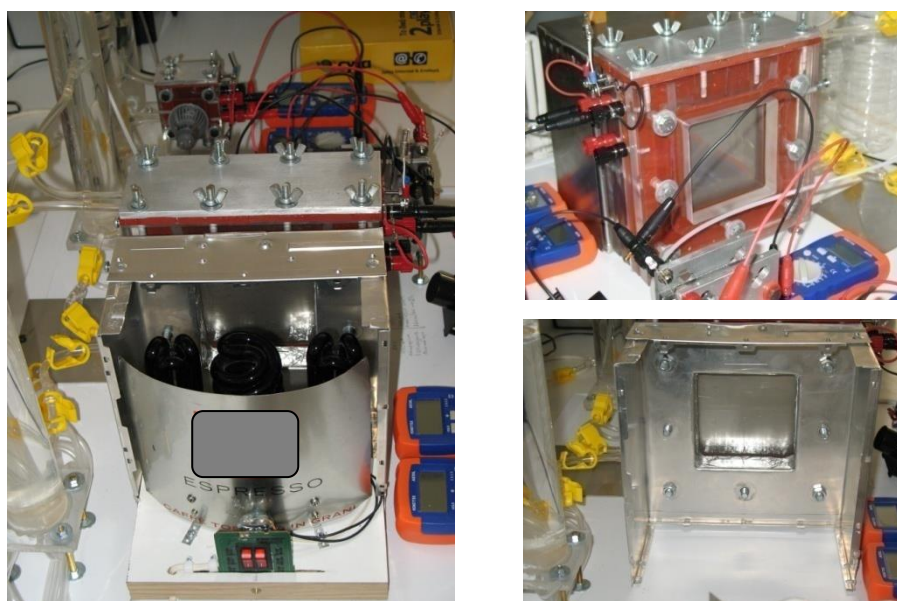
Εικόνα 2. Συναρμολόγηση & Δοκιμαστική Λειτουργία Θαλάμου UV
