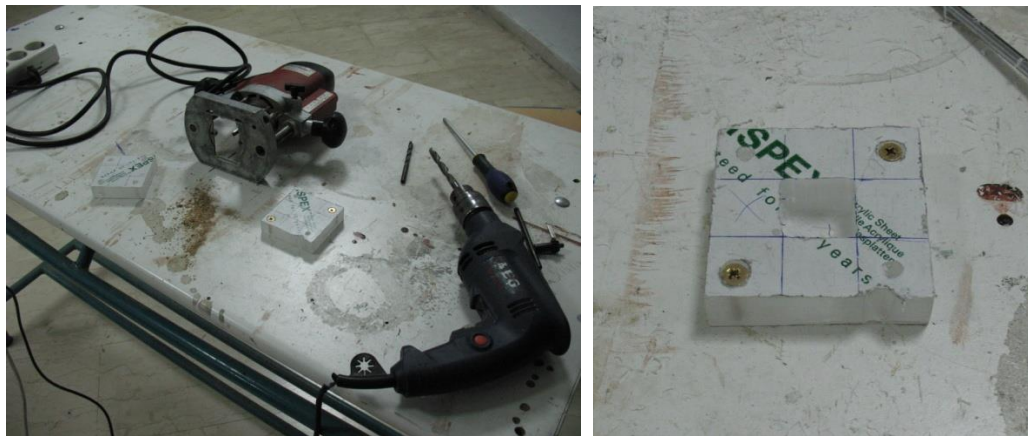
Εικόνα 1. Τοποθέτηση -I- Router κοπής με το εργαλείο: Κονδύλη Σκαλίσματος 6 mm
